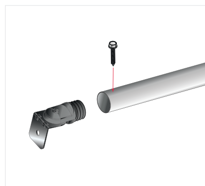
13 - Fixer les angles avec des vis autoforeuses 4,8 x 25.
