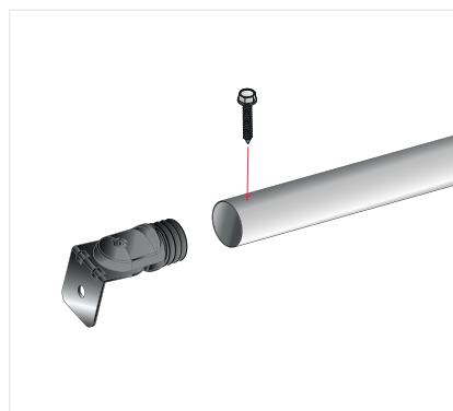
13 - Die Winkelstücke mit selbstbohrenden Schrauben 4,8 x 25 befestigen.
